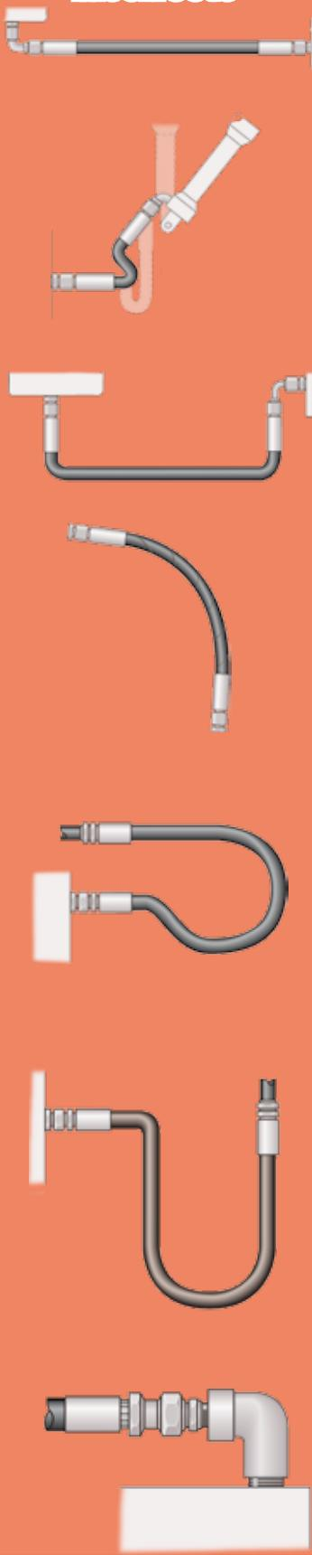
El **trazado** del latiguillo y el ambiente en el que funciona influyen directamente en su vida útil. Los diagramas siguientes indican el trazado correcto de latiguillos que maximizará su vida de servicio y garantizará un funcionamiento seguro.
